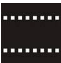
Ceļa apzīmējums Nr. 932. Vieta, kur brauktuvi vai gājēju ceļu šķērso velosipēdu ceļš, ceļa daļa velosipēdiem un elektroskrejriteņiem vai kopīgs gājēju un velosipēdu ceļš
